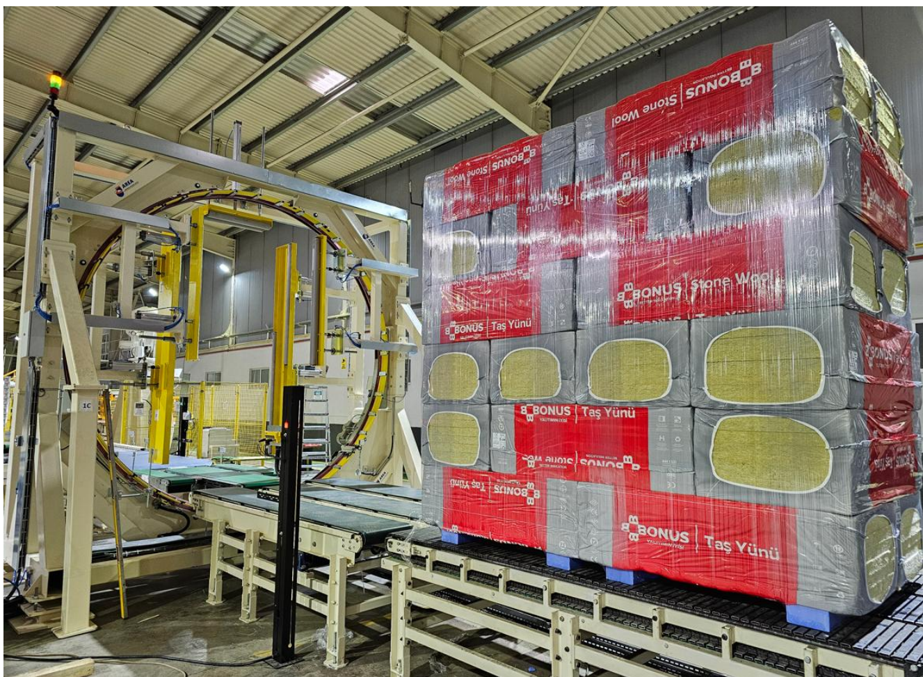
Na zdjęciu: owijarka AREA , model GF3 z olbrzymim pierścieniem owijającym, o średnicy = 3500 mm!
