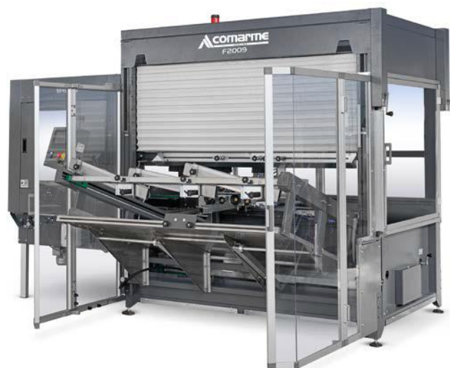
Na zdjęciu: składarka COMARME F2009 w konfiguracji z zaklejką COMARME B670
