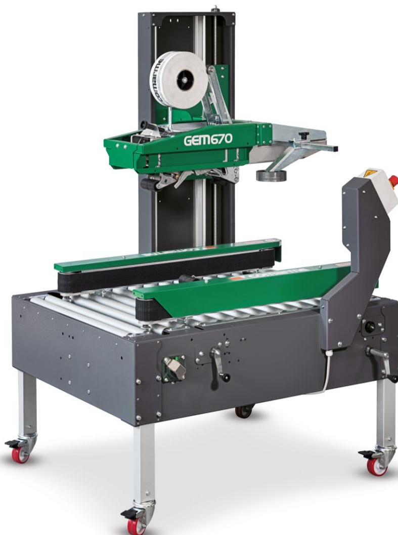
Na zdjęciu: zaklejarka do kartonów, model GEM 670 włoskiej firmy COMARME (siostrzana maszyna zaklejarki GEM 820 )
