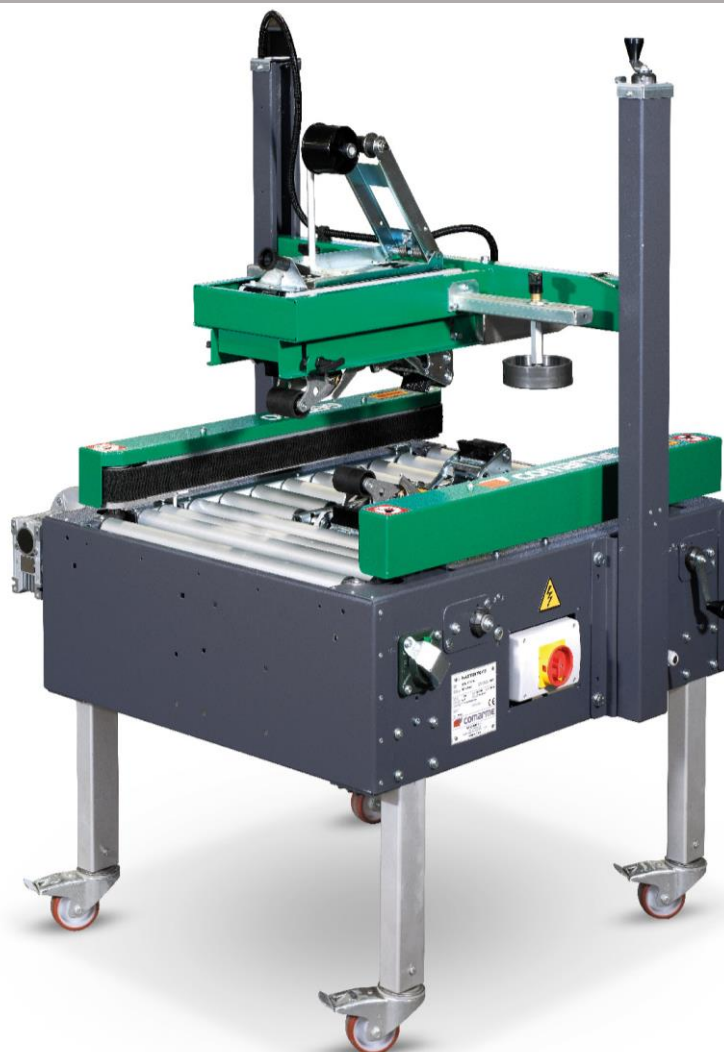
Na zdjęciu: zaklejarka do kartonów, model GEM 50 włoskiej firmy COMARME
