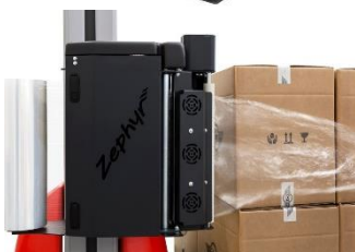
ZEPHYR nowy, automatyczny system mocowania i odcinania folii, współpracuje z wózkami MPS i MPS2
