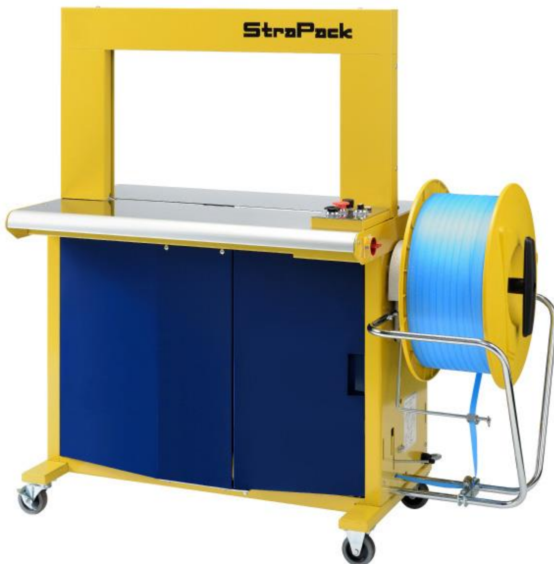
Na zdjęciu: wiązarka STRAPACK SQ-800S – automatyczna wiązarka stołowa, przeznaczona do wiązania małych paczek
