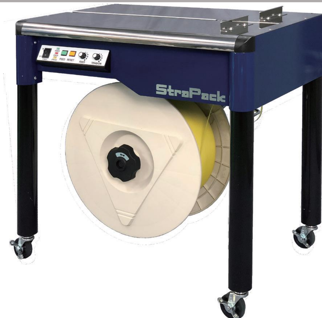
Na zdjęciu: wiązarka STRAPACK iQ-400 – półautomatyczna wiązarka stołowa, przeznaczona do wiązania paczek, kartonów itp.
