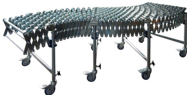
Podajnik z rolkami (krążkami) wykonanymi ze stali; 5 krążków na jedną oś
