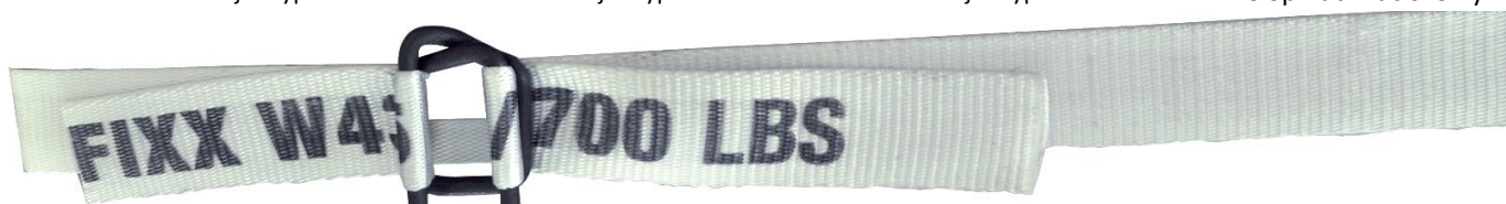
Przykładowe wiązanie z użyciem taśmy tkanej i spinacza zaciskowego, wykonane napinaczem H-26
