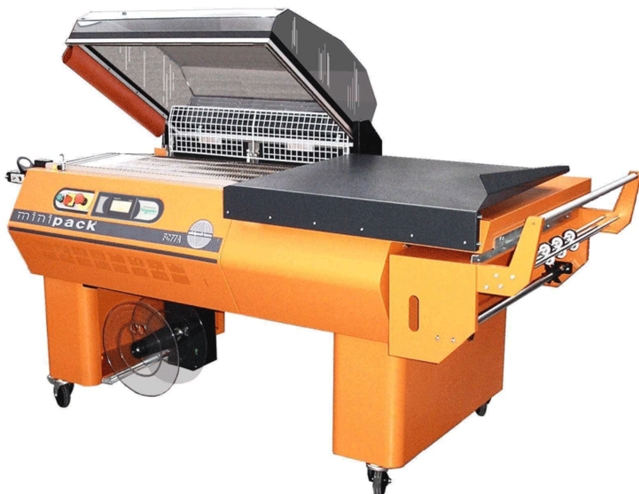
Na zdjęciu: maszyna do pakowania produktów w folię termokurczliwą, FC77A PLC, włoskiej firmy MINIPACK-TORRE
