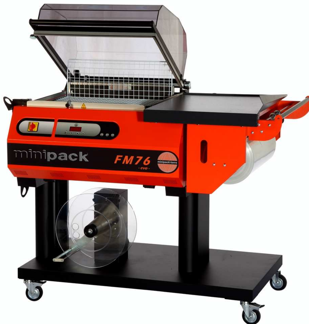
Na zdjęciu: maszyna do pakowania produktów w folię termokurczliwą, FM-76 EVO, włoskiej firmy MINIPACK-TORRE
