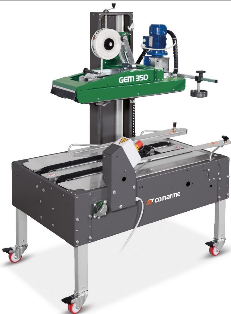
Na zdjęciu: zaklejarka do kartonów, model GEM 350 włoskiej firmy COMARME
