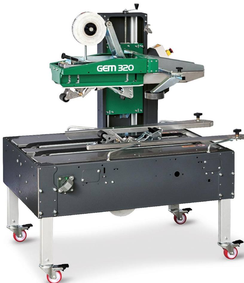
Na zdjęciu: zaklejarka do kartonów, model GEM 320 włoskiej firmy COMARME
