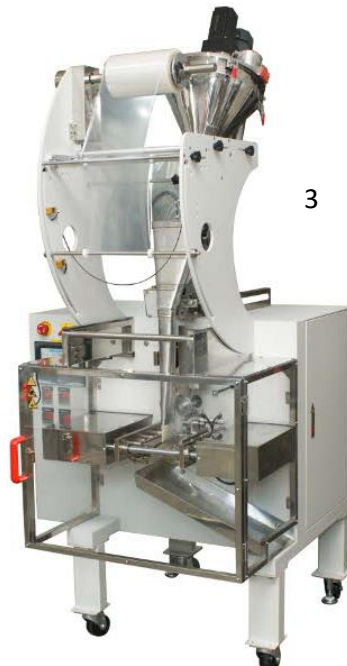
Maszyna CIA pakująca w saszetki, przeznaczona do produktów sypkich lub gęstych
